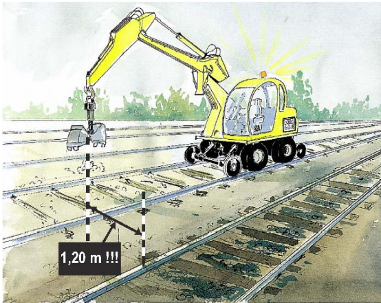
Een spoorgebonden kraan moet op 1,20 m van het nevenliggend spoor in dienst blijven.
